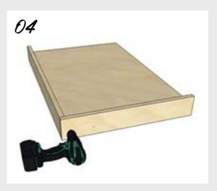
Sur la plaque n°1, tracez des marges de 1 cm dans la longueur et dans la largeur. Fixez les roulettes avec la visseuse dans les quatre angles. Sur les paires de plaques 2 et 3, tracez une marge de 4cm. ce sera la profondeur de notre plateau. Fixez ces plaques sur la plaque principale. N'oubliez pas de pré-percer avant de visser afin que le MDF n'éclate pas.
